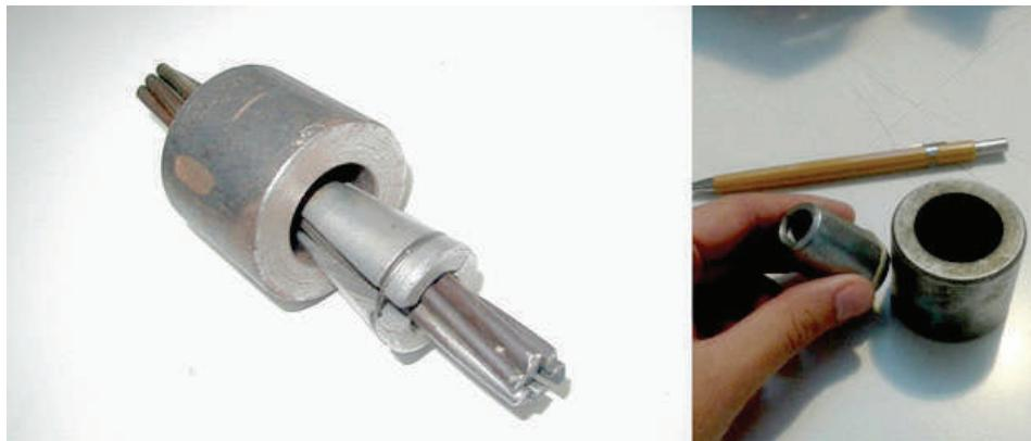
**Fig. I-36.** Os três elementos fundamentais para a ancoragem: a cordoalha, a cunha e o cilindro. (\*-7).
