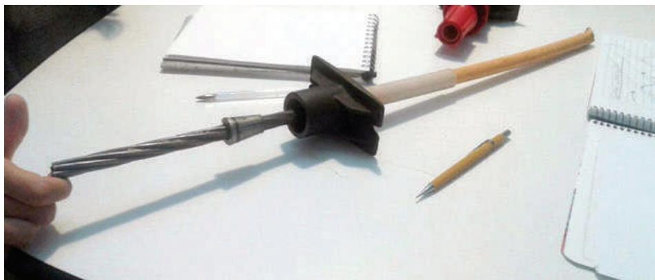
**Fig. I-38.** Veja a cordoalha, as cunhas fora do cilindro acoplado a uma chapa de aço para topo. A bainha é de plástico. (\*-7).
