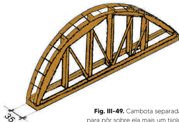
**Fig. III-49.** Cambota separada para pôr sobre ela mais um tijolo comum ou uma plaqeta tirada do tijolo especial. Com isso, aumenta a separação entre cambotas e permite fazer um arco transversal de reforço, mais resistente. (\*-5).
