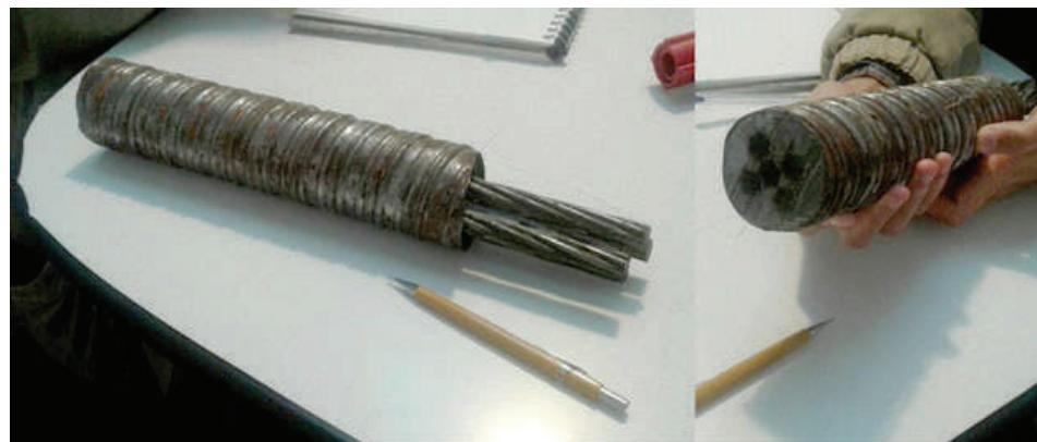
**Fig. I-37.** A cordoalha dentro de uma bainha de aço. (\*-7).
