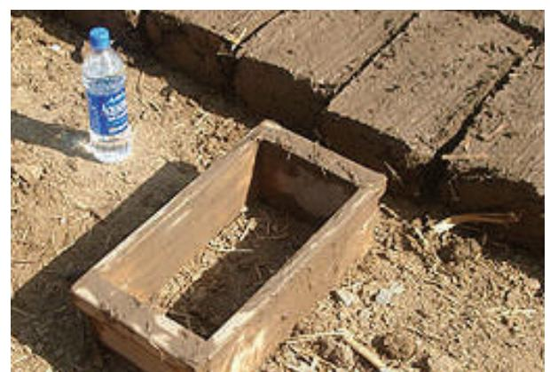
**Fig. X-3.** Mostra o tijolo cru feito de barro secando ao sol e o molde do tijolo. (\*-10).
