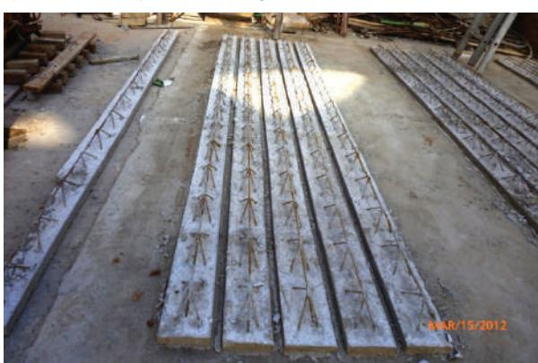
**Fig. VI-25.** Vigotas desmoldadas, a da esquerda foi rejeitada. (\*-5).
