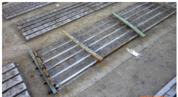
**Fig. VI-24.** Fabricação em bateria. (\*-5).
