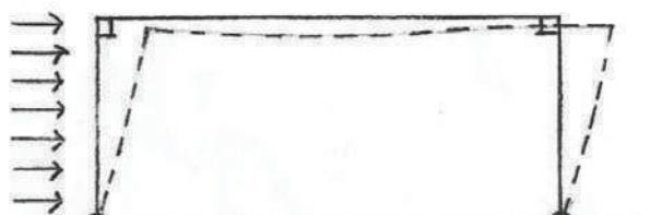
TENDENCIA DE DEFORMAÇÃO E DESLOCAMENTO DO PÓRTICO.
