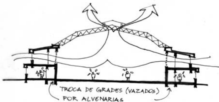
Figura 25 – ... Por alterações do programa, os vãos internos foram sendo lacrados, prejudicando a ventilação por diferença de temperatura.
